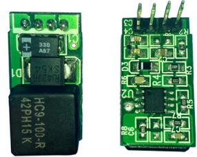
**輸入電壓****12, 15, 24, 36 VDC 標準電壓****輸出電壓****3.3 ~ 13 VDC**
